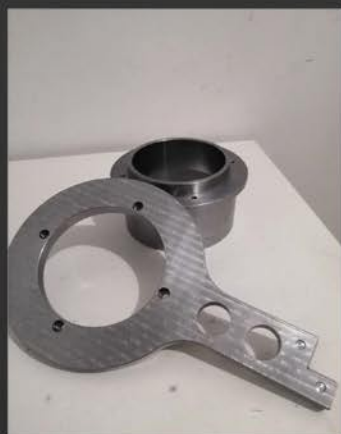
Fixture localizador para máquina de corte. Acero
