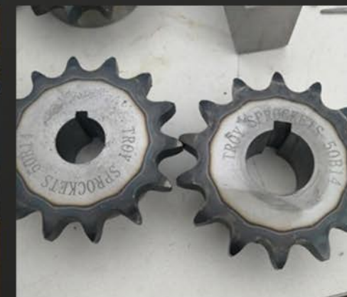
Calibración de Sprocket 14 Dientes
