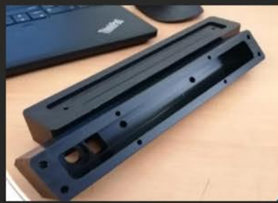
Cabezal para pruebas eléctricas
