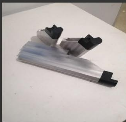
Fixture mordazas para máquina de medición. Aluminio y plástico.
